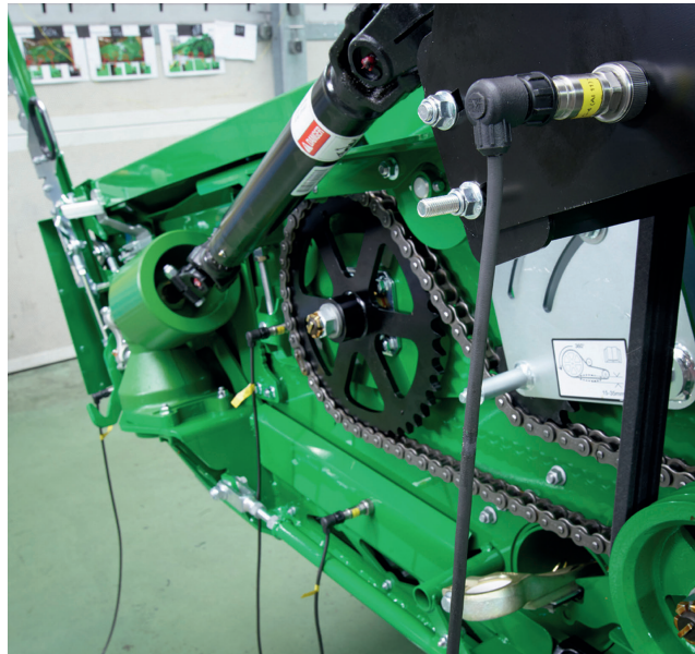
Bild 2. Mähdrescherschneidwerk auf dem Acoustix-Prüfstand bei John Deere.
